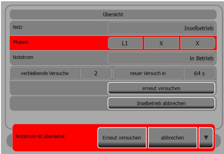
Abb. 81: „Übersicht“ beim Versuch in den Notstrom-/Inselbetrieb zu wechseln
