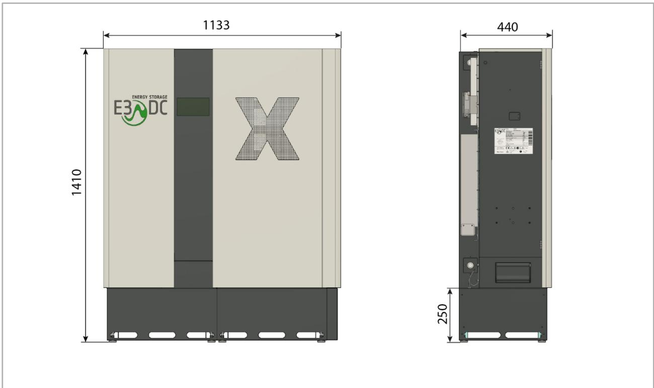
Abb. 11: Abmessungen elektrische Funktionseinheit und Batterieschrank nebeneinander aufgestellt (in mm)
