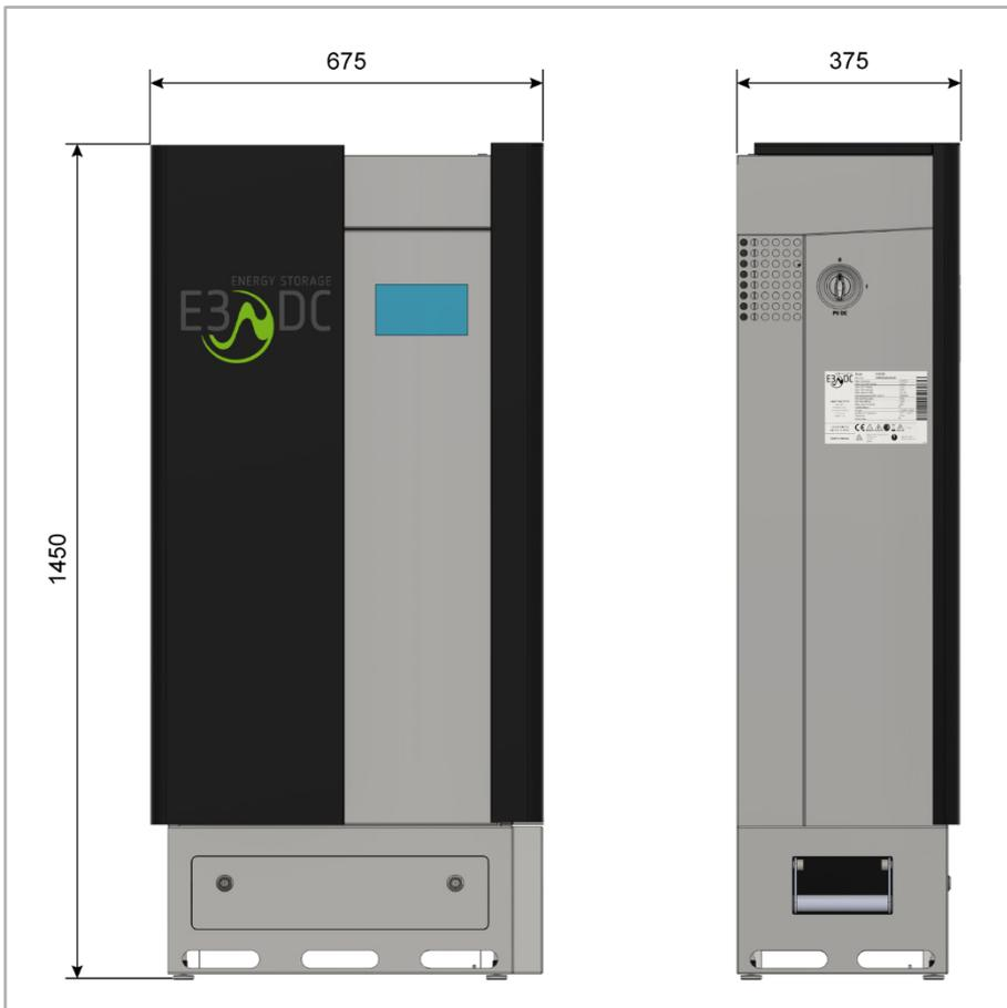
Abb. 14: Abmessungen elektrische Funktionseinheit (in mm)
