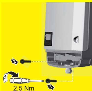
Використовуйте кріпильні гвинти для надійної фіксації інвертора на кронштейні, дотримуючись моменту затяжки, вказаного в інструкціях з експлуатації.
